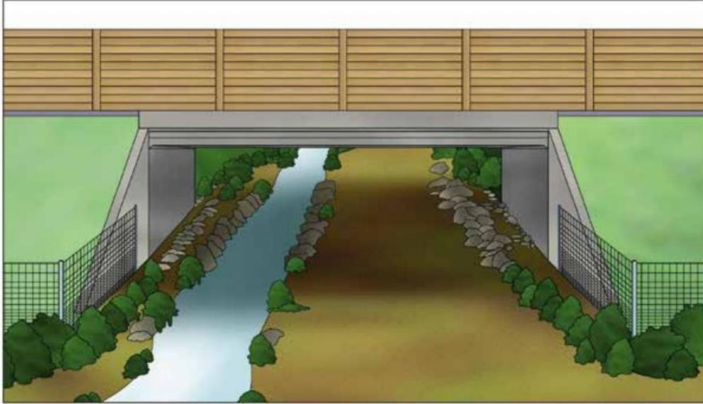
Figura 7.6. Disposición de una acequia en uno de los márgenes de la estructura, dejando amplias franjas destinadas al paso de fauna.
